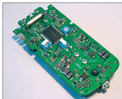
Bild 2: Multilayerleiterplatten von Contag für Atemalkoholmessgeräte von Dräger
