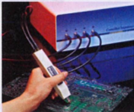
pischerweise liegen die geforderten Impedanzen bei 50  $\Omega$ , 60  $\Omega$ , 75  $\Omega$ , 100  $\Omega$  und 120  $\Omega$  Wellenwiderstand. Die üblichen Toleranzwerte liegen zumeist bei  $\pm 10\%$ , seltener bei  $\pm 5\%$  und kaum darunter. (mc)
