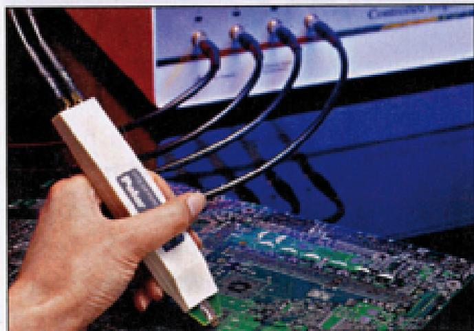
Fullservice an. Mit der Simulationssoftware Si8000 in Verbindung mit dem zugehörigen Impedanz-Messplatz können die Berliner von der Entwicklung bis hin zur Fertigungsoptimierung beraten und diese mit protokollierter Datenhaltigkeit fertigen. Kunden-Layouts werden durch die Arbeitsvorbereitung (CAM) analysiert und definierte Impedanzen auf technologische Machbarkeit hin überprüft. Für die Vorbereitung und Optimierung nutzt das Unternehmen die Software Si8000 von Polar Instruments.
